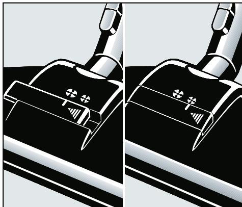
In alle andere gevallen moet de mechanische zuigkrachtregeelaar gesloten blijven zodat de vloerbedekking met de volle zuigkracht gereinigd wordt.
