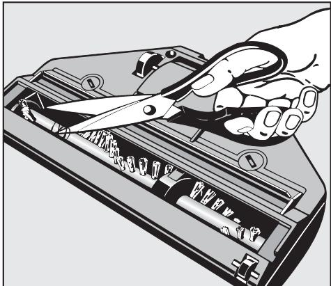
Om turboborsten är igensatt av smuts inuti borsten kan den öppnas. Större delar som sugits in kan då enkelt avlägsnas.
